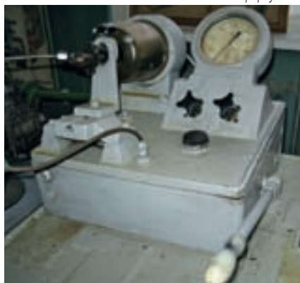
Стенд для регулировки форсунок дизельных двигателей позволяет определить начало впрыска, качество распыления топлива и отрегулировать давление впрыска топлива форсункой.
