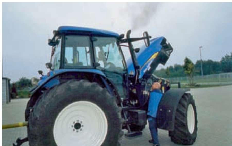
Цвет выхлопных газов говорит о качестве сгорания топлива, улучшить его можно за счет регулировки двигателя.
