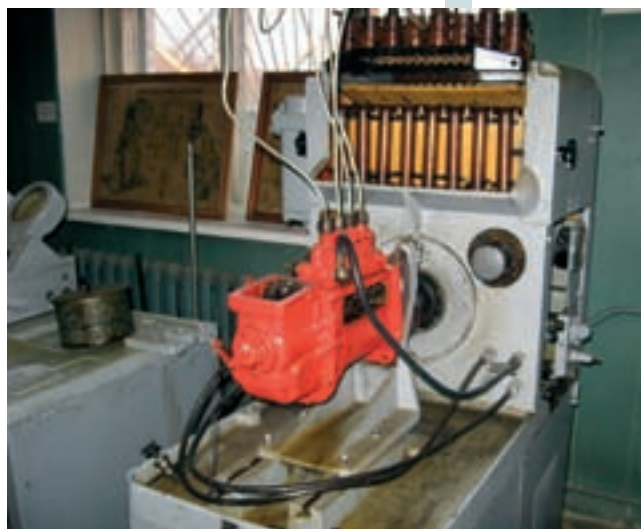
На стенде для регулировки топливных насосов высокого давления дизельных двигателей можно регулировать и определять такие параметры: начало действия регулятора; производительность каждой секции насоса; неравномерность подачи топлива между секциями насоса; угол начала впрыска топлива.
