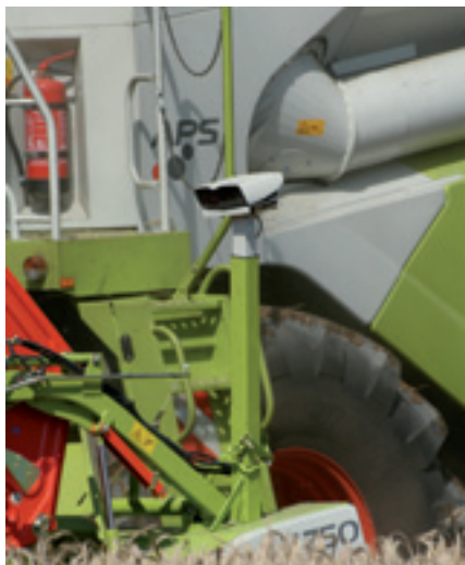
Автоматические системы рулевого управления с лазерным датчиком более выгодны по цене и надежнее в работе.
