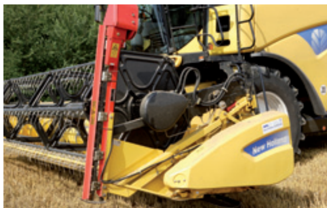
Быстрое переоснащение на уборку рапса благодаря жатке Variot: в большинстве случаев необходимо установить всего лишь боковые ножи-делители.
