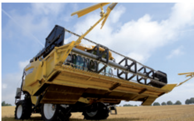
Для обеспечения равномерности среза до начала уборки необходимо проверить исправность копирующих полозьев или дуг (в зависимости от системы).
