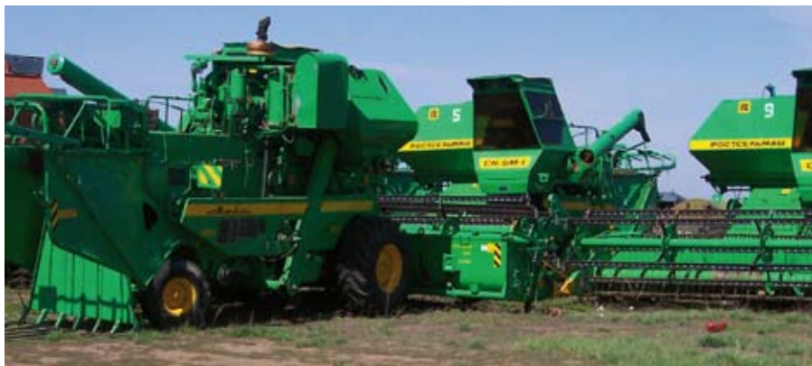
При хранении двигателей, особенно комбайновых, на открытом воздухе целесообразно накрыть их специальными чехлами из брезента, полимерной пленки или другого материала.
