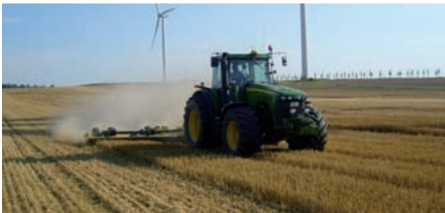
Высокий срез увеличивает производительность комбайна. Если стерня очень высокая – требуется мульчирование. Фотография редакции.
